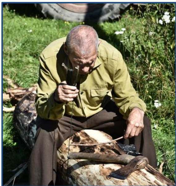
В.П. Медведев с помощью отвеса на бревне находит центр будущей лодки Фото: архив ОГАУК «ДНТ «Авангард», с. Инкино, Колпашевский р-н, 2022 г.
