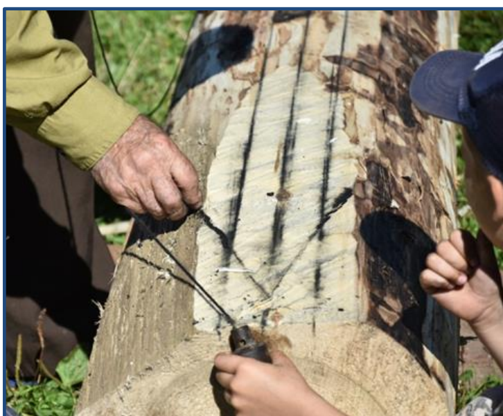
Разметка бортов и носа с кормой лодки с помощью отвеса с верёвкой, прокрашенной углём. Фото: архив ОГАУК «ДНТ «Авангард», с. Инкино, Колпашевский р-н, 2022 г.
