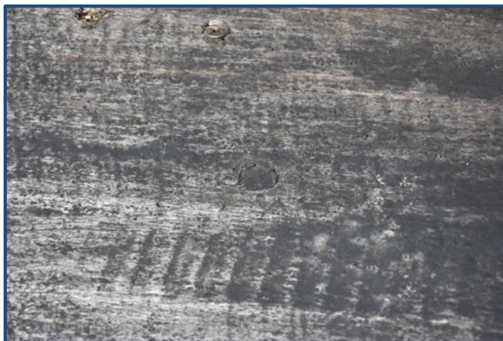
Сторожки в корпусе дна лодки-долбленки, вид снаружи. Фото: из архива ОГАУК «ДНТ «Авангард», с. Нельмач, Парабельский р-н, 2022 г.
